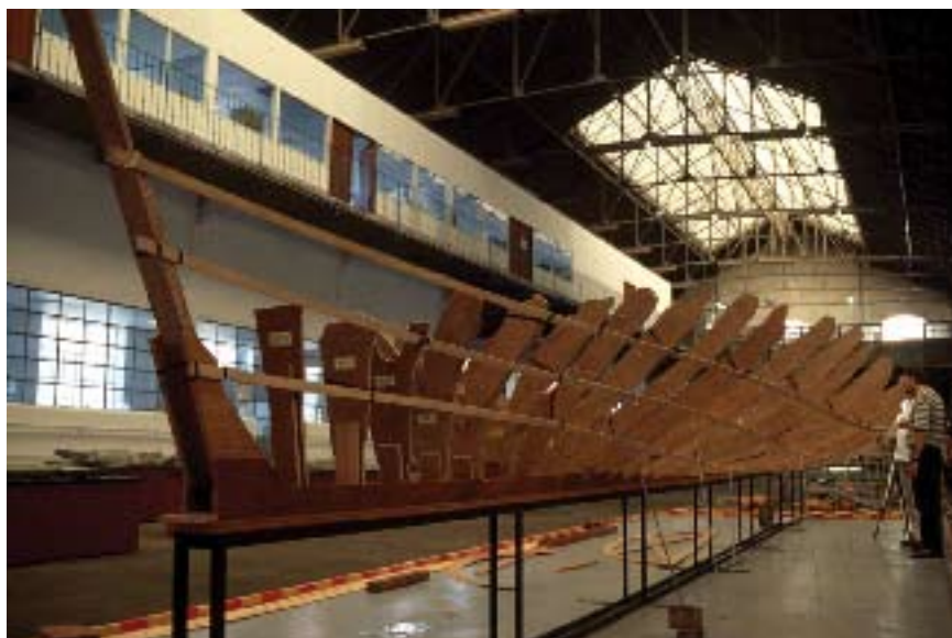
Figure 4: Maquettes en contreplaqué et en polyuréthane, dites en «2D» et «3D» de l'épave du 15ème siècle Ria de Aveiro A au CNANS
