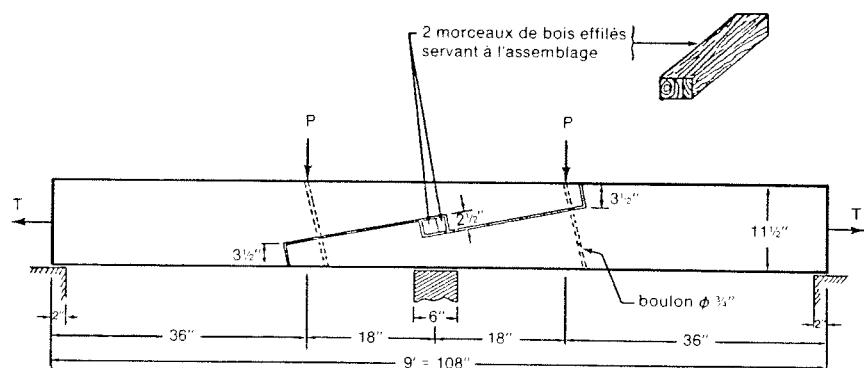
Fig. 12. — Vue schématique de la poutre en bois et du mode de chargement.
