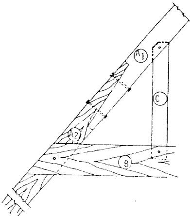
Fig. 9. Detail A. Assemblage sifflet à talon (boulonné et collé).
