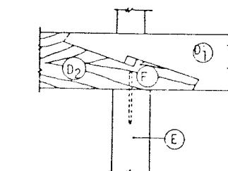
Fig. 10. Detail B. Assemblage enture à trait de jupiter (clé simple).
