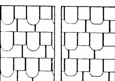
Fig. 5. Echantillon de motifs observés dans les revêtements de bardage traditionnels à Saint-Apollinaire.
