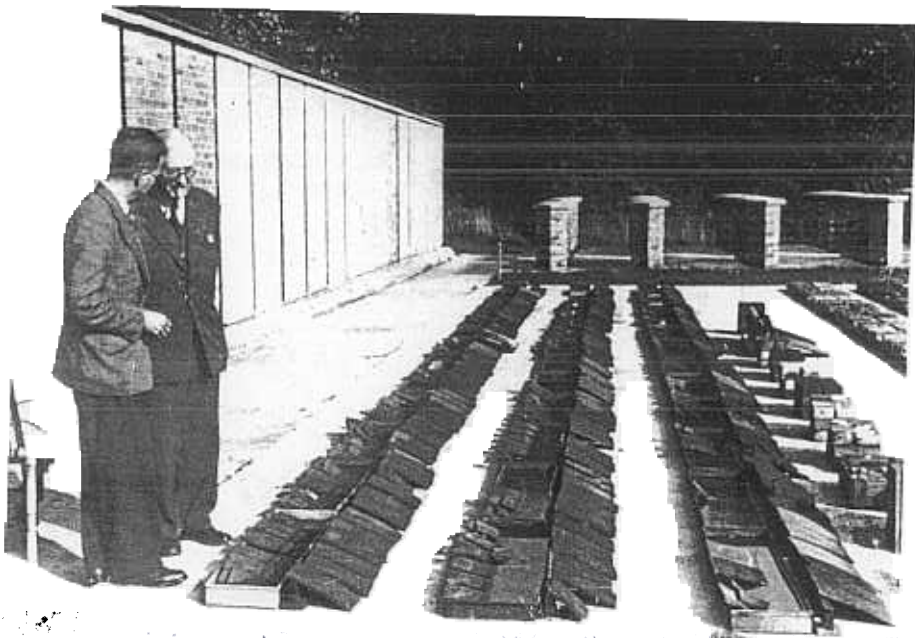
Fig. 3. - Exposition d'échantillons ou "exposure tests" dans un institut spécialisé.
