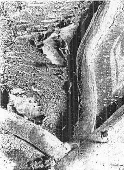
Abb.14. Akuter Schwarzlotzerfall: Die deckenden Konturen sind bereits verwittert (weiße Striche); der Halbtonüberzug rollt sich wie eine Folie vom Glasträger ab. Ursache ist Schwitzwassereinfluß, möglicherweise durch Feinbrand gefördert (Herford, St. Johannis, Detail einer Wappenscheibe, 3.V.14. Jh)
