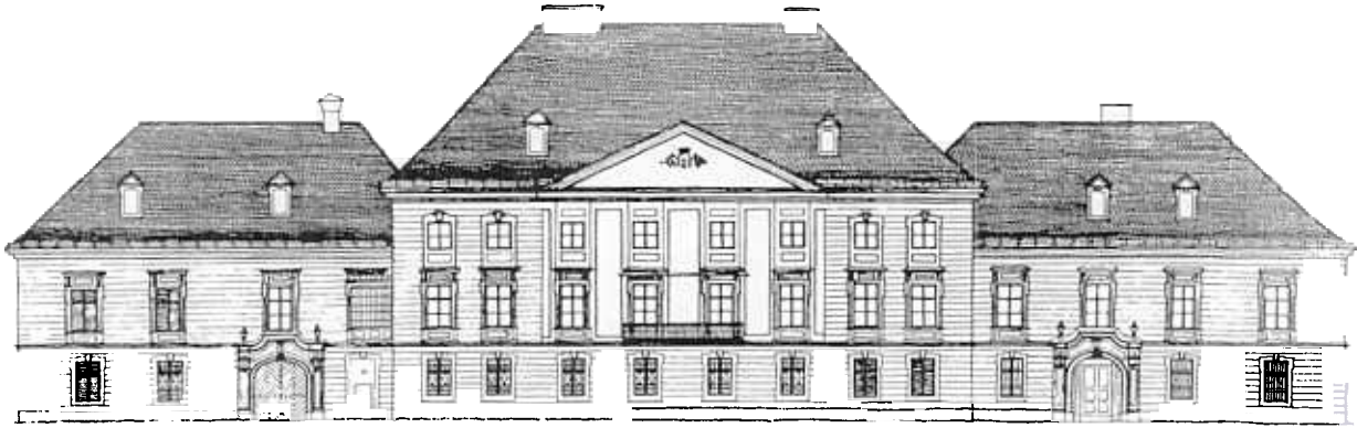
Fig. 6. — Un exemple de restitution à la chambre claire. Le château de Neuhohenwang, Autriche. Echelle de l'original 1/100. (Document B D A, Vienne.)
